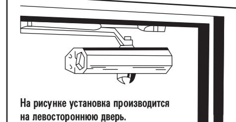
На рисунке установка производится на левостороннюю дверь.
