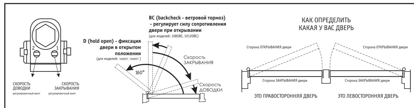
**ВНИМАНИЕ: ЗАПРЕЩАЕТСЯ ВРАЩАТЬ РЕГУЛИРОВОЧНЫЕ ВИНТЫ ПРОТИВ ЧАСОВОЙ СТРЕЛКИ БОЛЕЕ ЧЕМ НА ДВА ПОЛНЫХ ОБОРОТА ОТ ЗАВОДСКОЙ УСТАНОВКИ, ТАК КАК ЭТО МОЖЕТ ПРИВЕСТИ К ВЫПАДАНИЮ ВИНТА ИЗ КОРПУСА, ПРОТЕЧКЕ ЖИДКОСТИ И ПОЛОМКЕ ИЗДЕЛИЯ. НЕ ПЫТАЙТЕСЬ САМОСТОЯТЕЛЬНО ОТКРЫТЬ КОРПУС ДОВОДЧИКА - ЭТО ОПАСНО ДЛЯ ЖИЗНИ И МОЖЕТ ПРИЧИНИТЬ ВРЕД ВАШЕМУ ЗДОРОВЬЮ. ДОВОДЧИК ПОДЛЖЕТ УТИЛИЗАЦИИ В ЗАВОДСКИХ УСЛОВИЯХ СПЕЦИАЛЬНО ОБУЧЕННЫМИ ЛЮДЬМИ.**
